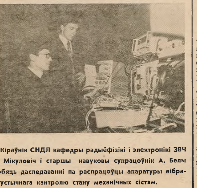
Кіраўнік СНДЛ кафедры радыёфізікі і электронікі ЗВЧ У. Мікуловіч і старшы навуковы супрацоўнік А. Белы робяць даследаванні па распрацоўцы апаратуры вібраакустычнага кантролю стану механічных сістэм.
